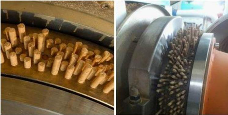
Gambar 36. Proses terbentuknya formasi pellet kayu/pellet energi pada pelletiser jenis *ring die* (Sumber foto: GI)
