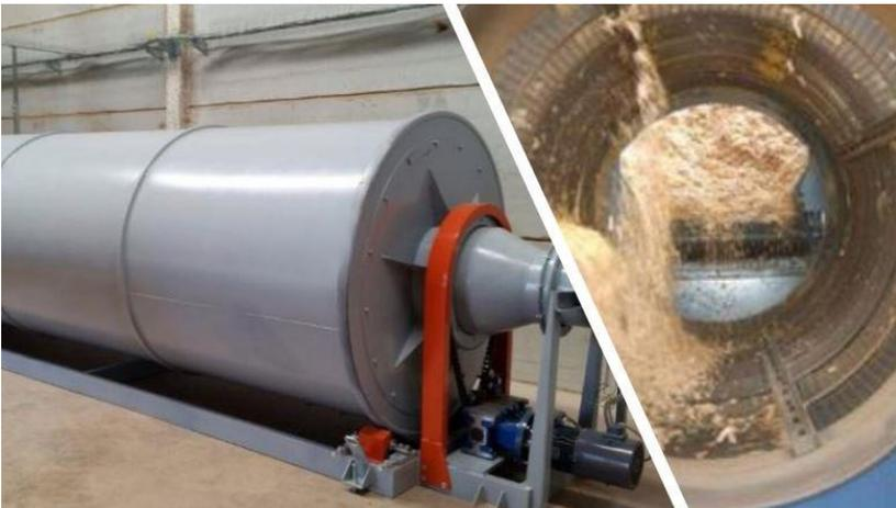
Gambar 34. Drum dryer yang banyak digunakan pada proses pengeringan serpih (*chip*) maupun serbuk kayu pada industri pellet kayu/pellet energi (Sumber foto: GI)
