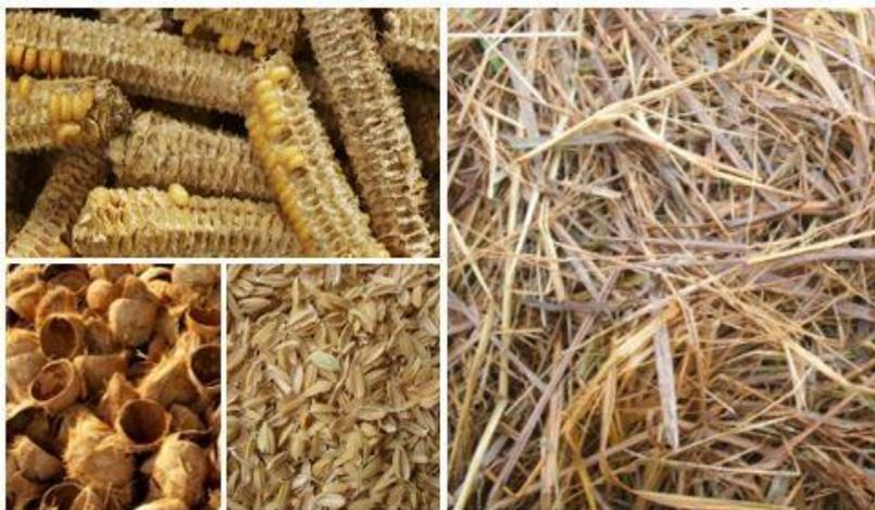
Gambar 20. Limbah pertanian seperti tongkol jagung, batok kelapa, sekam padi dan jerami berpotensi digunakan sebagai bahan baku pellet energi (Sumber foto: GI)
