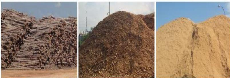
Gambar 33. Log/kayu bulat, chip (serpih) dan serbuk kayu yang biasa digunakan dalam industri pellet kayu/pellet energi (Sumber foto: dokumen pribadi)
