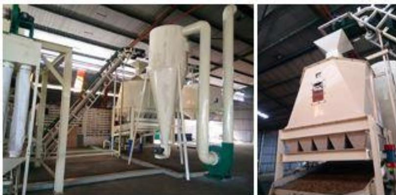
Gambar 38. Menara pendingin (*cooling tower*) pada industri pellet kayu/pellet energi (Sumber foto: GI)
