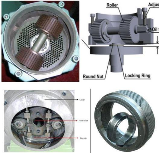
Gambar 35. Jenis alat cetak/kempa pada industri pellet kayu (*die*): *flat die* (atas) dan *ring die* (bawah) (Sumber foto: GI)
