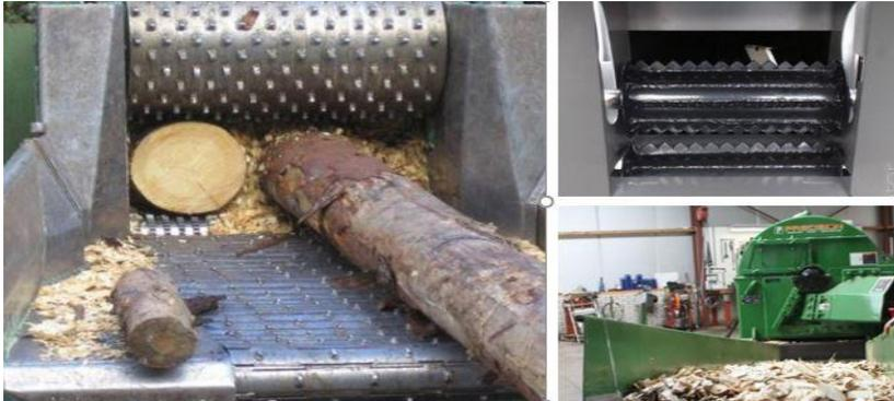
Gambar 32. *Wood chipper* bertenaga besar yang mampu mencacah log menjadi serpih kayu (Sumber foto: GI)
