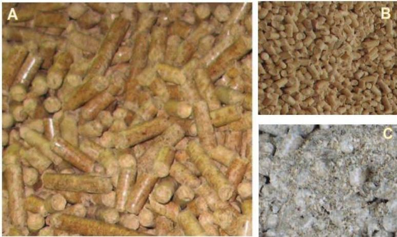
Gambar 42. Perbandingan kualitas pellet kayu didasarkan pada kekuatan struktur mekanisnya: A. pellet dengan kualitas yang baik; B. pellet dengan kualitas sedang dan C. pellet kayu kualitas rendah, struktur pellet hancur menjadi remah (Kofman, 2007).
