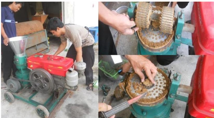
Gambar 37. Pelletiser atau alat pencetak pellet kayu sederhana dengan penggerak diesel (Sumber: Amirta et al, 2018)
