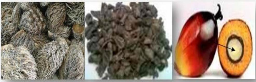
**Gambar 1. Limbah Padat Sawit yang Digunakan Sebagai Bahan Baku Bio-pellet. Tandan Kosong (Kiri), Cangkang (Tengah) dan Bungkil Kernel (Kanan)**
