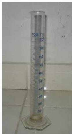
Gambar 19. Gelas Ukur Yang Dipakai Untuk Mengukur Jumlah Curah Hujan.
