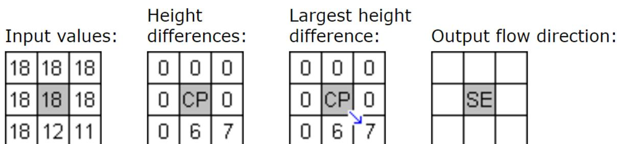
**Gambar 2.** Konsep perhitungan flow direction untuk setiap cell
