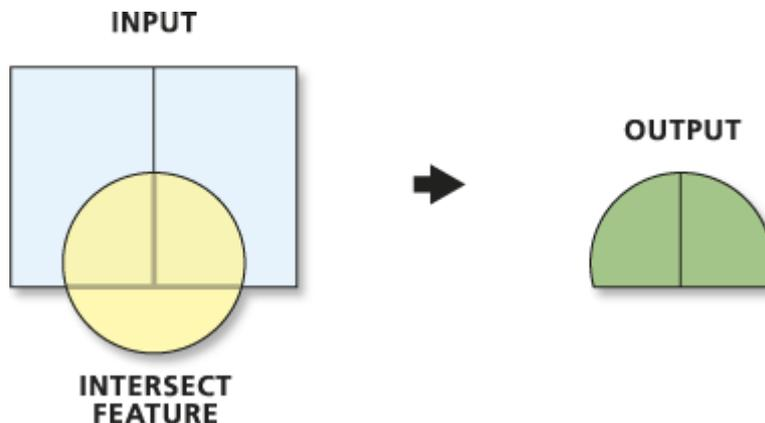
**Gambar 3.** Skema proses dalam fungsi "Intersect"
