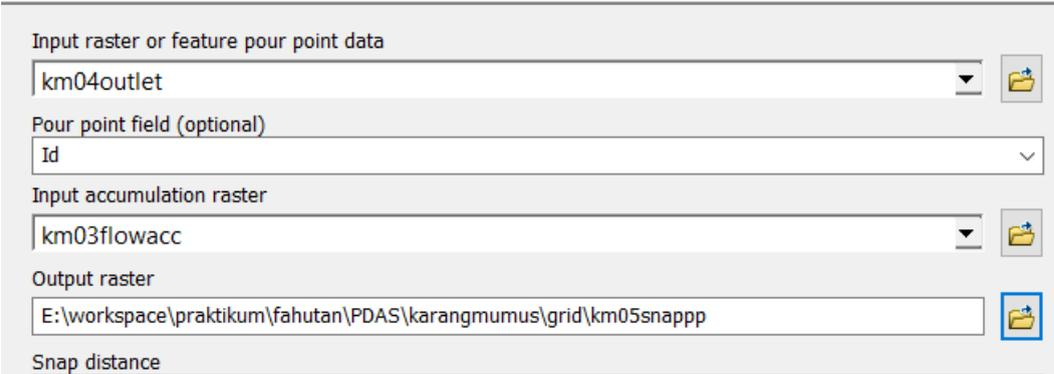
**Gambar 8.** Dialog box data input dan output pada proses "Snap Pour Point"
