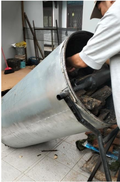
Gambar 8 Pengisian bahan baku biochar ke dalam drum retort
