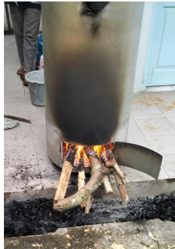
Gambar 7 Proses pembuatan biochar dengan metode retort
