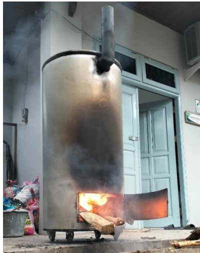
Gambar 7 Proses pembuatan biochar dengan metode retort
