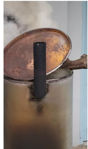
Gambar 7 Proses pembuatan biochar dengan metode retort
