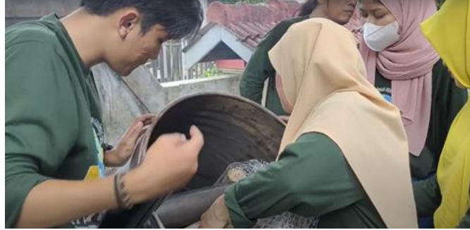
Gambar 8 Pengisian bahan baku biochar ke dalam drum retort
