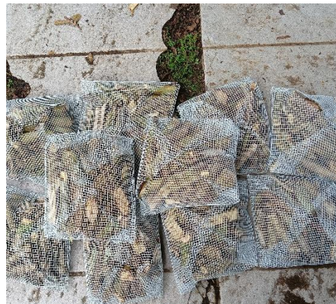
Gambar 2 Menimbang dan membungkus bahan pembuatan biochar dengan kassa kawat
