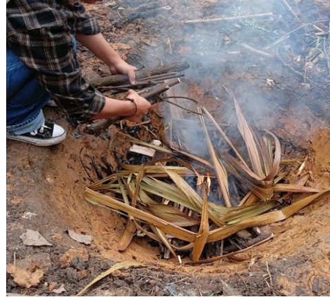
Gambar 1 Meletakkan dan membakar bahan bakar pembuatan biochar metode konvensional ke dalam lubang pembakaran
