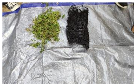
Gambar 5 Bahan baku sebelum dan sesudah dibuat menjadi biochar dengan metode retort
