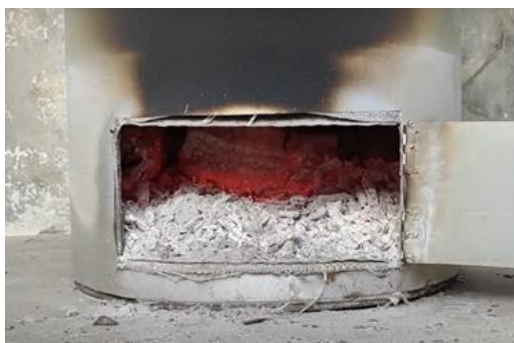
Gambar 6 Drum retort yang sedang dalam proses pembuatan biochar
