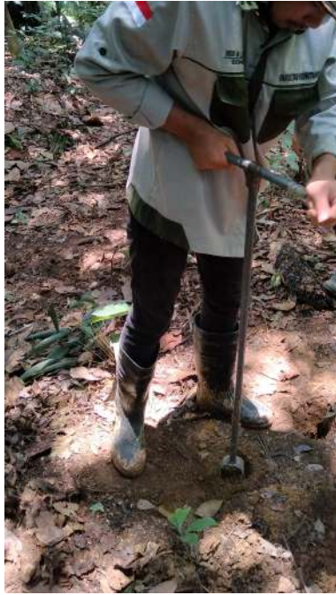
Gambar 2 Pengambilan Sampel Tanah Terganggu Menggunakan Bor Tanah
