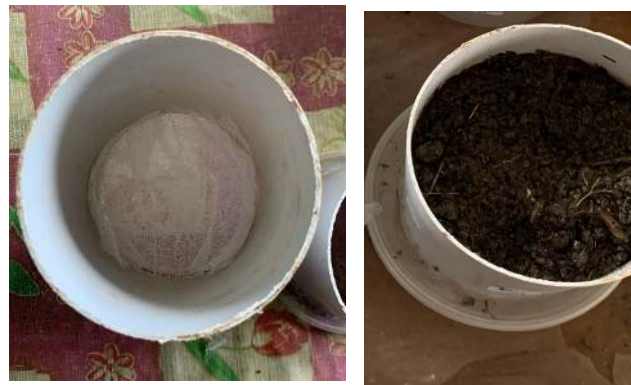
Gambar b. Tabung Perkolator yang telah diberi kain kassa dan diisi sampel tanah
