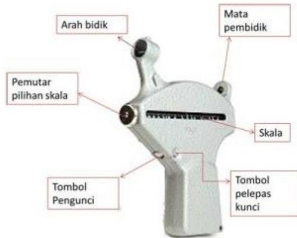
Hingga kini jarak dari objek ke titik pengamatan harus diukur dengan tangan. Dimana ada semak-semak tebal atau hambatan lain ini mungkin sulit dan untuk tujuan ini pengintai optik sebagai smoll telah dibangun yang bias diperbaiki dengan mudah ke Haga Altimeter.
